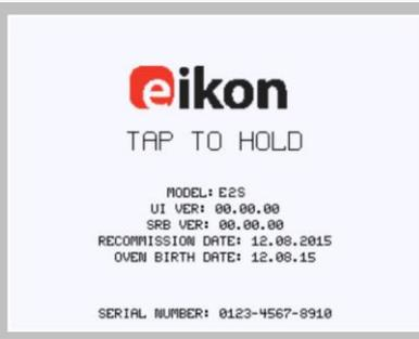
Загорается экран easyTouch®, на котором на короткое время отображается серийный номер и характеристика печи.
