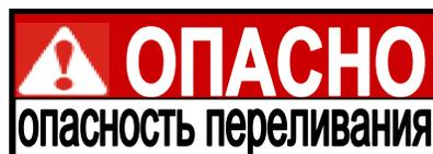
НЕ ЗАПОЛНЯЙТЕ ЖАРОЧНУЮ ЕМКОСТЬ МАСЛОМ ВЫШЕ ВЕРХНЕГО ИНДИКАТОРА. НЕВЫПОЛНЕНИЕ ЭТИХ ИНСТРУКЦИЙ МОЖЕТ СТАТЬ ПРИЧИНОЙ ПЕРЕПОЛНЕНИЯ ЖРОЧНОЙ ЕМКОСТИ МАСЛОМ, ЧТО МОЖЕТ ПРИВЕСТИ К СИЛЬНЫМ ОЖОГАМ, ТРАВМАМ, ПОЖАРУ И/ИЛИ ПОЛОМКЕ ОБОРУДОВАНИЯ.
