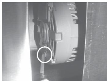
16. Залейте свежее масло в жарочную емкость. Мотор фильтра оборудован кнопкой ручного сброса, которая используется в случае перегрева мотора, эта кнопка расположена на задней стороне мотора. Перед тем как сбросить защитное устройство, подождите примерно 5 минут, чтобы мотор остыл. Для сброса снимите панель, которая находится на левой стороне аппарата. Для сброса потребуется приложить усилие, либо можно воспользоваться отверткой.
