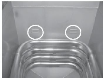
2. Газовые аппараты вмещают 59 кг (130 фунтов) масла. На задней стенке жарочной емкости находятся четыре линии, указывающие нужный уровень масла. См. фото слева.
