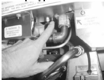
Этот датчик температуры измеряет температуру масла, и если температура масла выше 216°C (420°F), то контроллер прекратит нагрев жарочной емкости. После того, как температура масла упадет до безопасного уровня, следует вручную сбросить датчик, нажав на кнопку расположенную под панелью управления в передней части аппарата.
