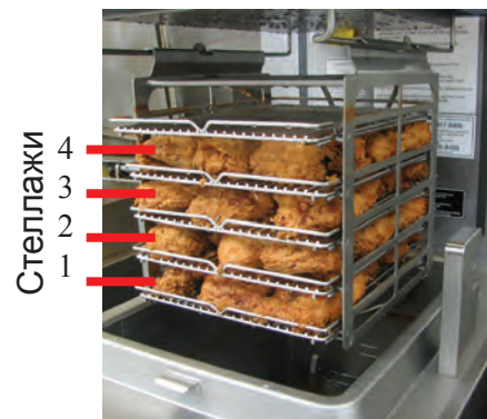
Полная загрузка 8 курицами (использованы все 4 стеллажа)
