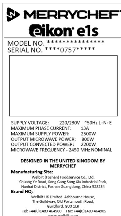
Рисунок 22. Табличка с техническими данными печи e1
