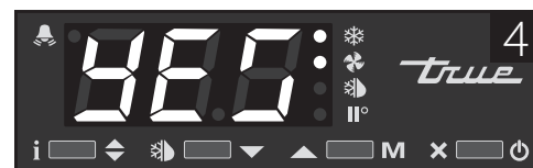
Рис. 4: Если на экране отображается сообщение "yes", терморегулятор заблокирован.
