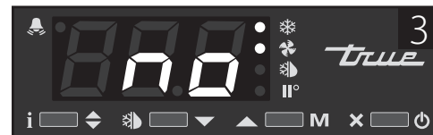
Рис. 3: Если на экране отображается сообщение "no", терморегулятор разблокирован.
