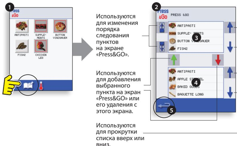
Используются для изменения порядка следования пунктов на экране «Press&GO».
